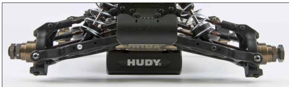
Zet je buggy of truggy op de droopblokken zodat het chassis vrijkomt van de grond.
