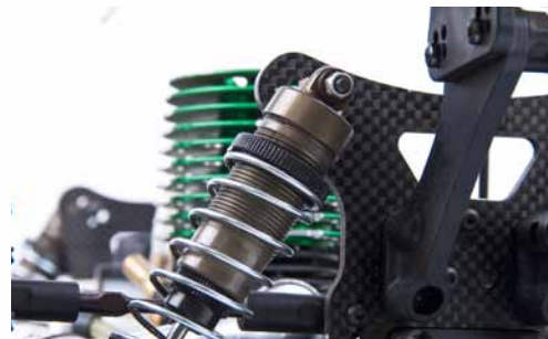
Met de stelmoer kun je eenvoudig de rijhoogte instellen.
