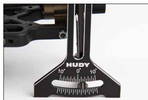
De schaalverdeling is heel duidelijk waardoor je tot een halve graad nauwkeurig af kunt stellen.
