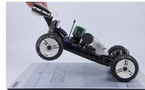
Laat zowel de voor- als achterkant een keer naar beneden vallen, zodat de schokdempers inzakken naar de rijklaar hoogte.
