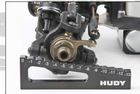
Als iedereen aan de onderkant van het schroefdraad op de wielmeenemer meet kunnen gegevens van verschillende wagens eenvoudig met elkaar vergeleken worden.
