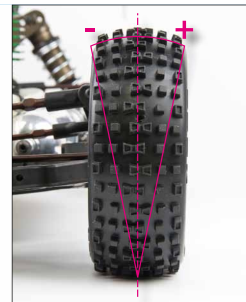
Bij negatief camber staat de bovenkant van het wiel naar het chassis toe.
