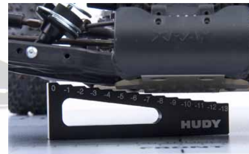
Meet de rijhoogte altijd op het vlakke deel van het chassis.
