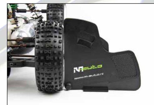
Een goedkoop meetgereedschap dat helaas niet altijd even nauwkeurige resultaten oplevert, de echte hoek van het afgebeelde wiel was anderhalve graad naar binnen, volgens dit basic hulpmiddel was het echter nauwelijks meer dan nul graden. Wel goed te gebruiken om links en rechts met elkaar te vergelijken.
