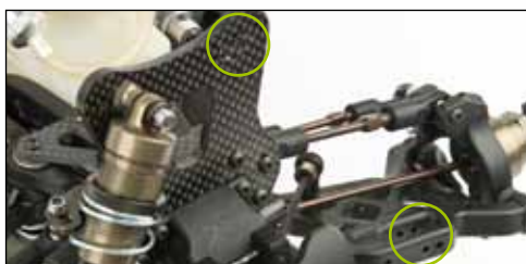
In het voorbeeld zie je duidelijk de twee gaatjes in de draagarm en de twee rijen met drie gaatjes naast elkaar in de shocktower.
