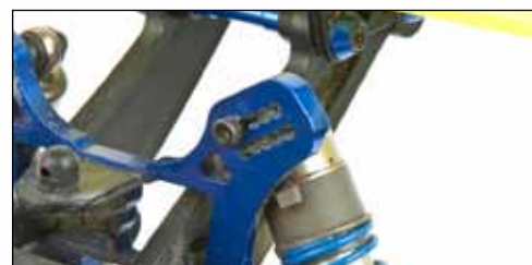
Op deze shocktower heb je een waaier aan mogelijkheden voor de afstelling van de positie van de schokdemper waardoor het veel lastiger is om de wagen af te stellen.
