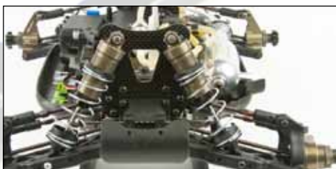
De rechter schokdemper in de middenste stand op de shocktower.
