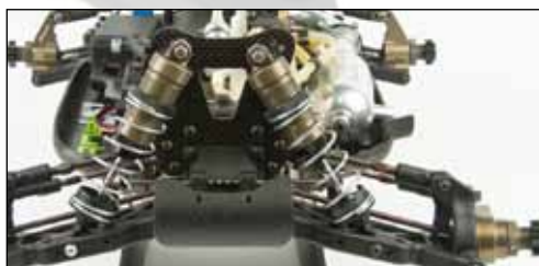
De rechter schokdemper in de meest binnenste stand op de shocktower.
